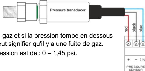
Le capteur surveille la pression d'alimentation en gaz et si la pression tombe en dessous de 0,17 psi, la vanne de gaz se ferme car cela peut signifier qu'il y a une fuite de gaz.
